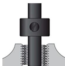
**Шаг 4.** Поместите специальный инструмент на поводок и резким, но не сильным, ударом отломите поводок.
