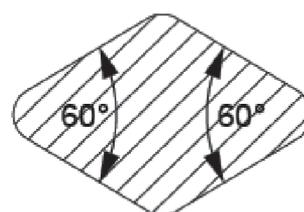
Вставки, по умолчанию, изготавливаются из нержавеющей стали А2. Возможно изготовление вставок из бронзы, стали А4, специальных хромоникелевых сплавов Nimonic и Inconel, с кадмированием и т.п.
